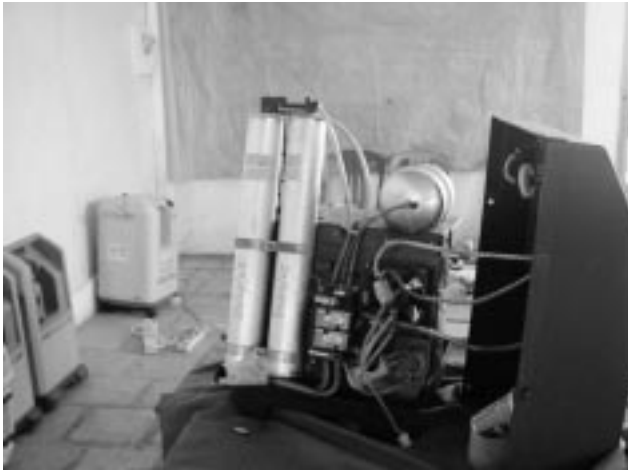
Figure 4 - Concentrateur d'oxygène démonté : la presseuse et les 2 colonnes de Zéolithe
